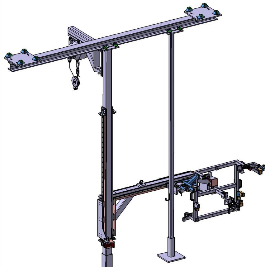
Einstellhilfe mit Manipulator für Transportgehänge
